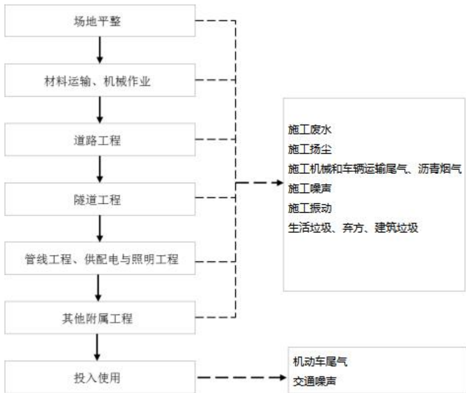
图 2-18 施工工艺流程图
