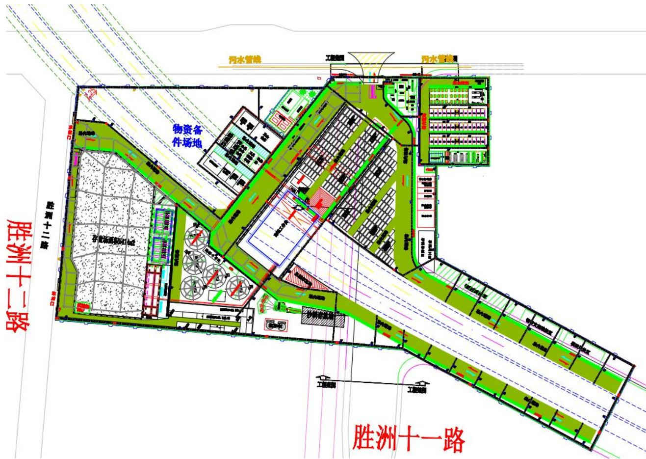
图 2.6-6 项目南岸施工场地平面布置图
